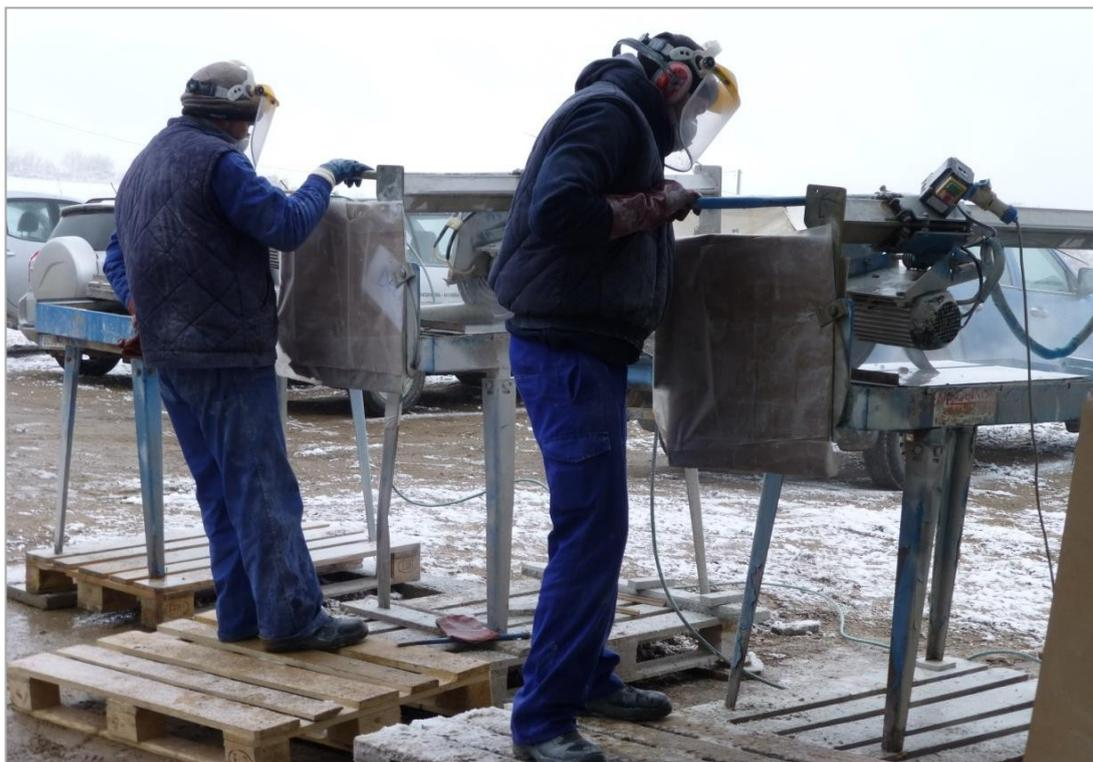
Figura 11-1: Muestreo de testigos de perforación diamantina en el proyecto Penouta
